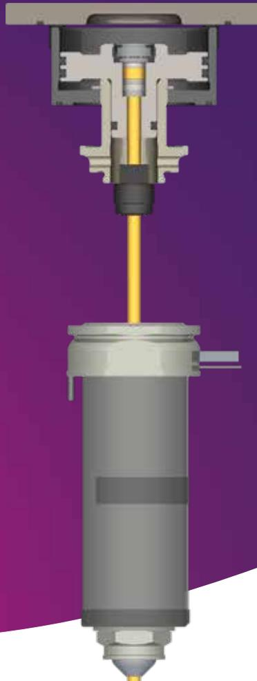
**Das MVG55 (Manifold Valve Gate) System ist ideal für Anwendungen mit mittlerem bis großem Schussgewicht, die eine sequentielle Befüllung oder hochpräzise Anspritzverschlüsse erfordern.**
