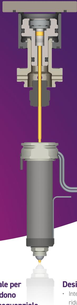
**Il sistema di otturazione MVG25 è l'ideale per piccole a medie applicazioni che richiedono interassi ridotti, cicli veloci, iniezione sequenziale e qualità estetica elevata.**
